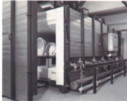
Four à sole mobile dans l'industrie de la céramique
