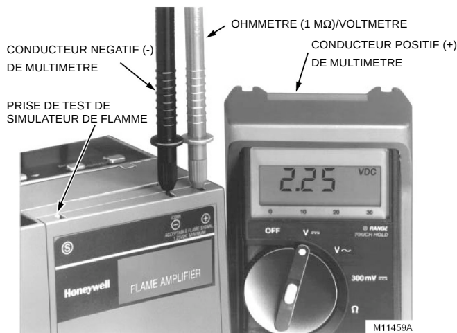
Fig. 4. Mesure de signal de flamme à l'aide d'un multimètre.
