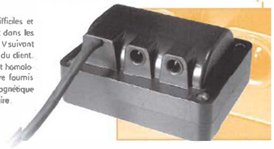
sorties Code SPRAS Fiche affleurante Ø 4 (profondeur 13,5 mm) Code SP Fiche Ø 4 excentrique (profondeur 21,5 mm) Code SPPRO Trou Ø 6 Fiche Ø 4 pour câble Ø 5,2 (profondeur 35 mm) Code SPMAN Fiche Ø 4 avec manchon (profondeur 23 mm) Code VIRAS Vis-taroud affleurante (profondeur 18 mm) Code VIMAN Vis-taroud avec manchon (profondeur 25 mm)
